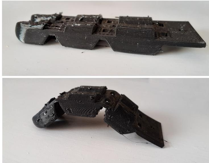
Figura 27. Pre doblado de falanges con calor.
