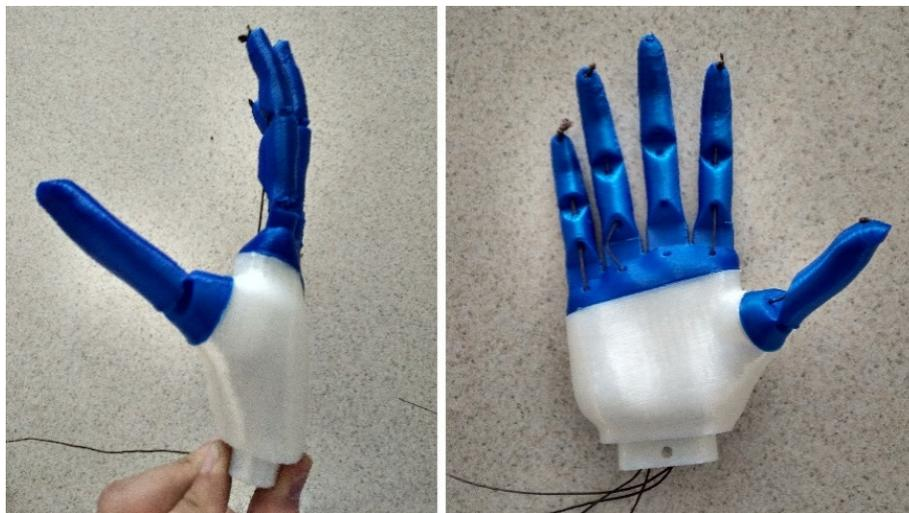
**Figura 17. Modelo de pieza con palma impresa en PLA y falanges impresas en TPU.**
