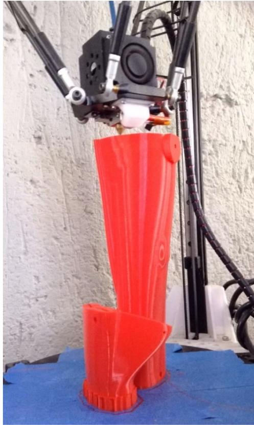
Figura 36. Impresión conjunta de socket y dispositivo terminal.
