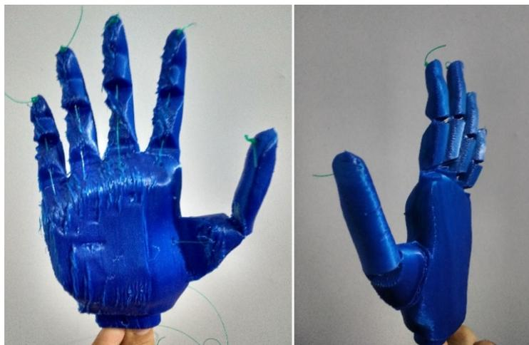
**Figura 16. Modelo de pieza completa de mano con muescas, impresa en TPU.**
