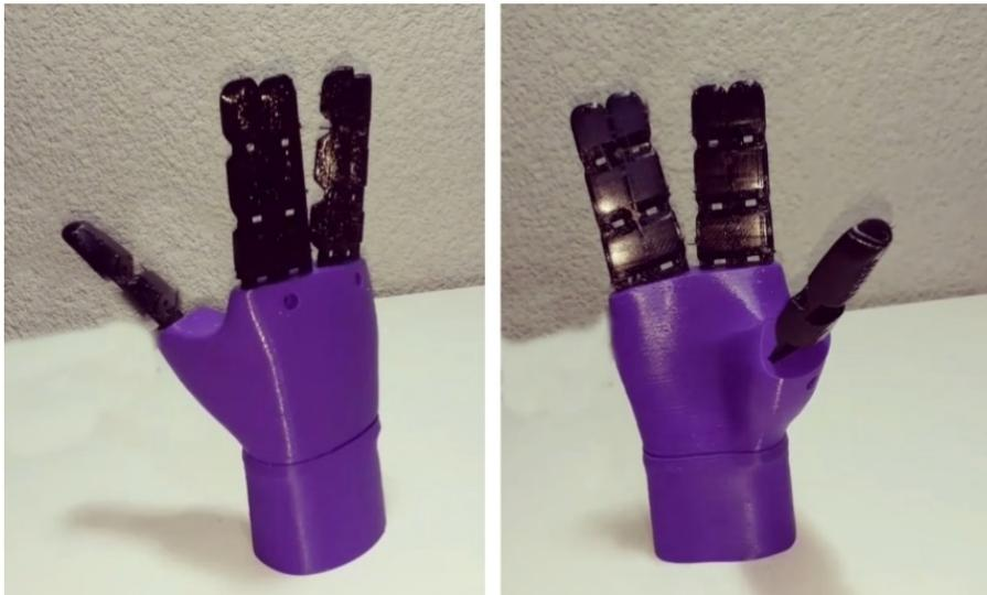
Figura 26. Dispositivo terminal de tres dedos, con apariencia de cinco.
