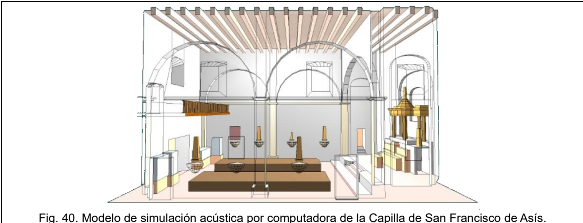
Fig. 40. Modelo de simulación acústica por computadora de la Capilla de San Francisco de Asís.
