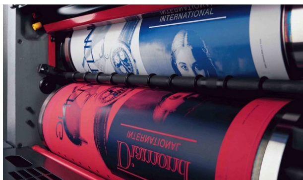
Figura 201. Rodillos de impresión del sistema Off-set .
