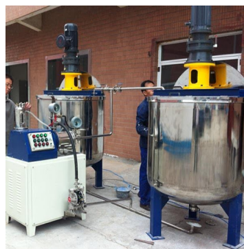
Figuras 203 y 204. Depósitos dosificadores de tintas para impresión.
