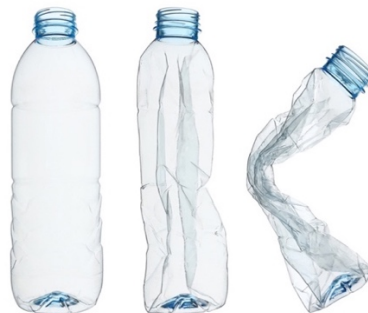
Figura 142. Imágenes que muestran deformación debido a una estructura semirígida.
