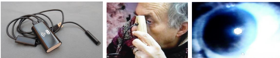
Figuras 46 mostrando izquierda pantalla, Oftalmoscopio cámara HD, al centro colocación de cámara frente al ojo del paciente, derecha pantalla teléfono indica fotografía del ojo del paciente.
