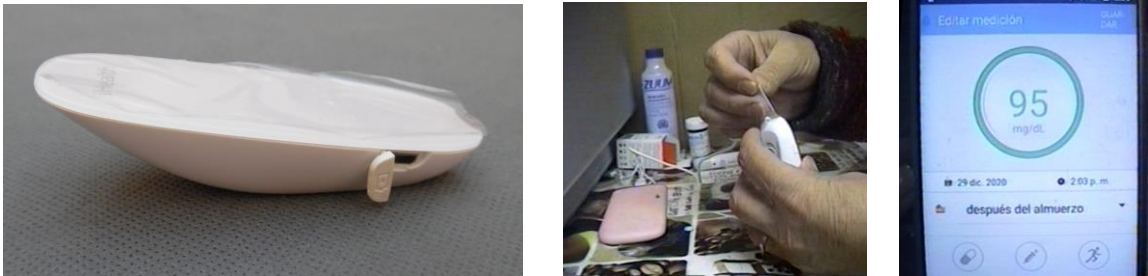
Figuras 45 mostrando izquierda pantalla, Glucómetro electrónico, al centro colocación de la tira reactiva en el glucómetro, para colocarle una gota de sangre, del paciente, derecha pantalla teléfono indica lectura de 95 mg/dl en sangre.
