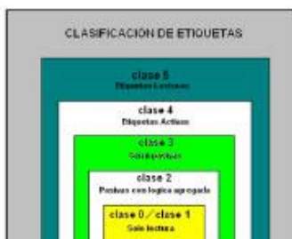
Figura 18 esquemática de las diferentes clases o tipos de etiquetas de RFID.
