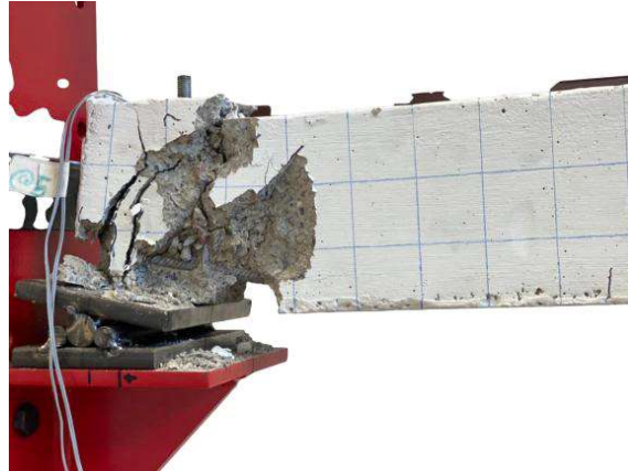
Figura 44. Detalle de la falla en el espécimen VR03.
