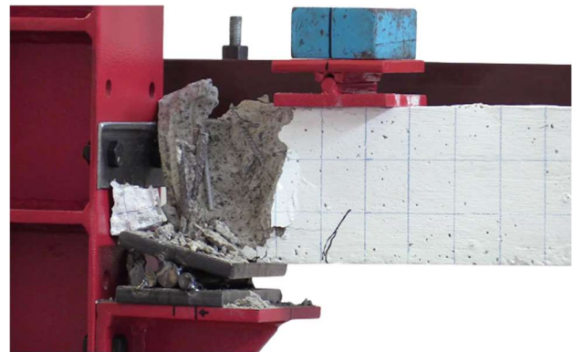
Figura 48. Detalle de la falla en el espécimen VR04.
