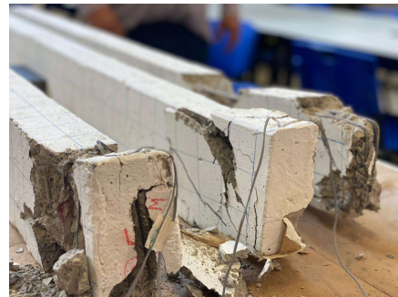
Figura 61. Detalle de falla en los extremos.
