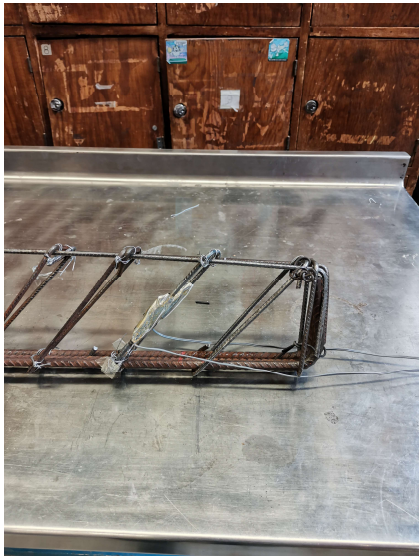
Figura 55. Ubicación de los strain gages en acero.
