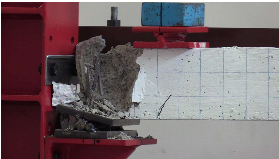
Figura 61. Detalle de falla en los extremos.
