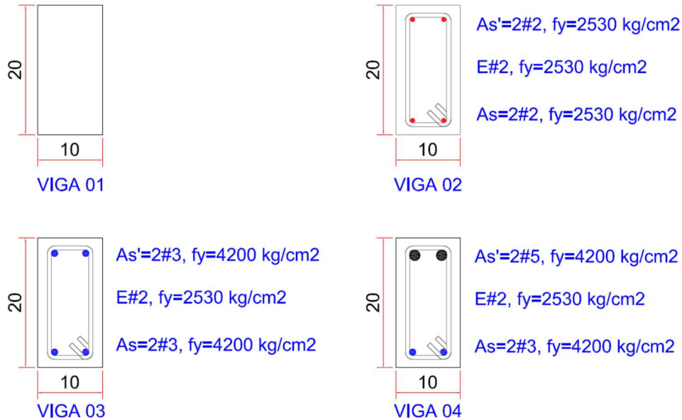
Figura 5. Armado de las vigas.
