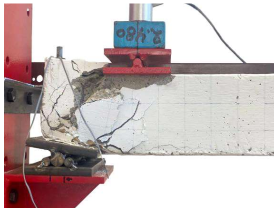
Figura 40. Detalle de la falla en el espécimen VR02.
