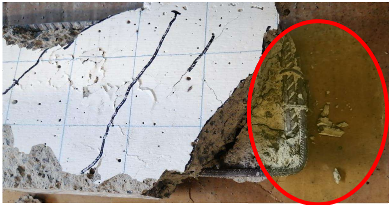
Figura 50. Detalle de los ganchos del refuerzo longitudinal.
