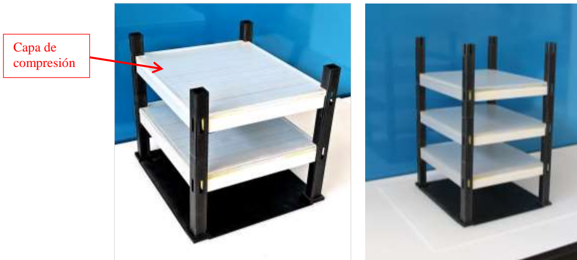
Figura 12. Colocación de firme o capa de compresión que complementa el sistema de losas alveolares en cada entrepiso.
