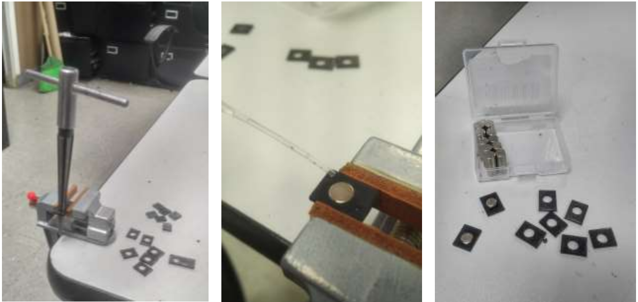
Figura 15. Proceso de inserción de imanes de neodimio en placa horizontal de las ménsulas.
