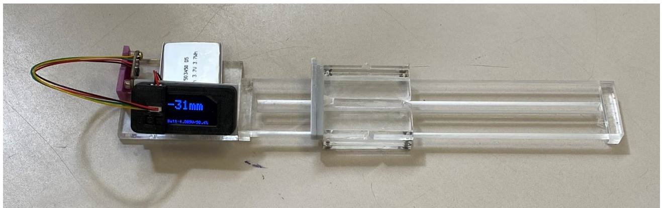
Figura 4. Elementos del Prototipo SD 71. Regleta base, cursor, pantalla (display), control emisor láser, batería.
