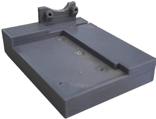
Figura 6 Soporte del Emisor - Receptor Láser
