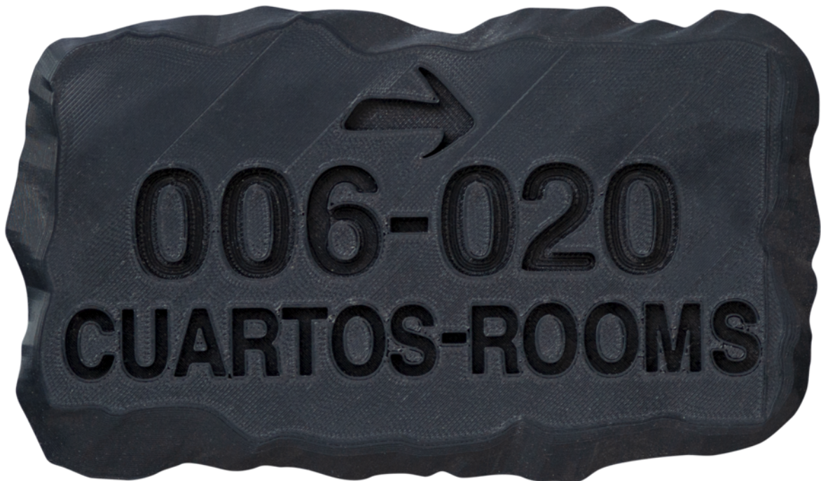
Fig. 109 Primera prueba de la impresión, la calidad en la impresión se sacrificó un poco en función de la velocidad.
