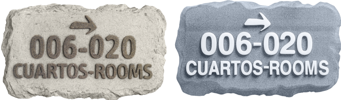
Fig. 117 pieza original (izquierda), junto a la pieza impresa en 3D (derecha).
