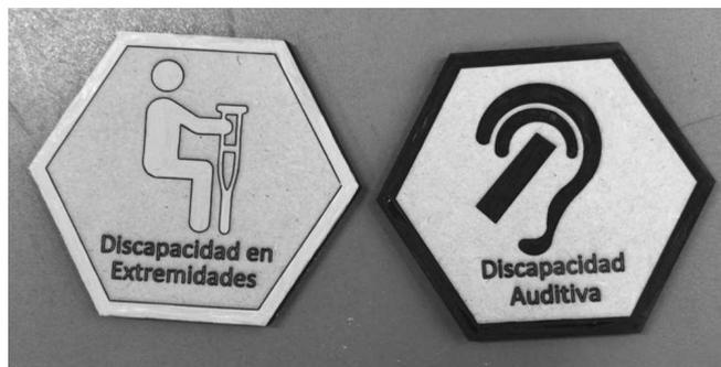
El segundo prototipo se realizó en impresión en resina con el marco y el icono en alto relieve, en este se maneja el negro con amarillo, generando un buen contraste.
