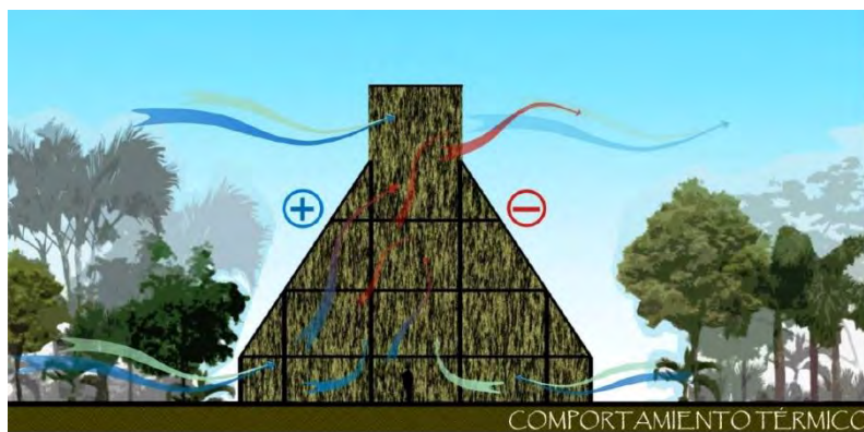
Fig. 44 Comportamiento térmico de la Maloca 38
