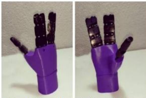
Se reemplazó el pulgar flexible por material rígido para facilitar la oposición
