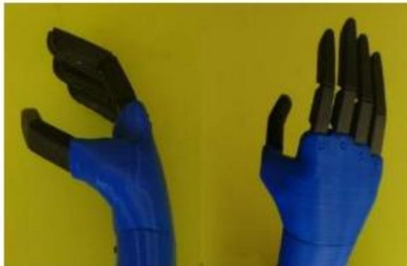
Se reemplazó el cordón de nylon por cordón especial para pesca y se unieron dedos índice-medio y meñique con anular para disminuir fricción y minimizar el esfuerzo para flexionar
