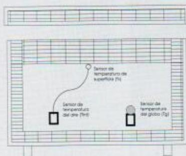
Figura 9a. Sección módulo control (MC)
