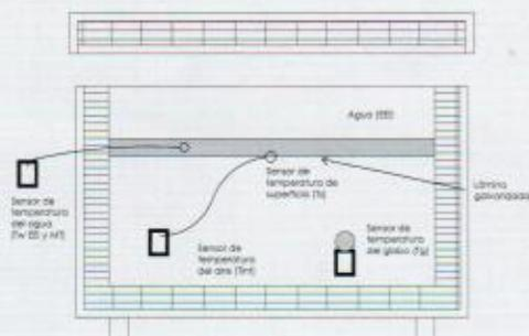
Figura 12a. Sección del módulo para la evaluación de la TEP: EEI/AT+ERN (Luis Carlos Herrera Sosa).
