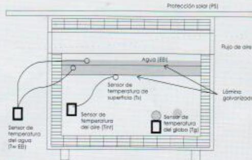
Figura 11a. Sección del Módulo para la evaluación de las TEP: EEI/PS +MT y EEI/PS+MT/ERN (Luis Carlos Herrera Sosa).
