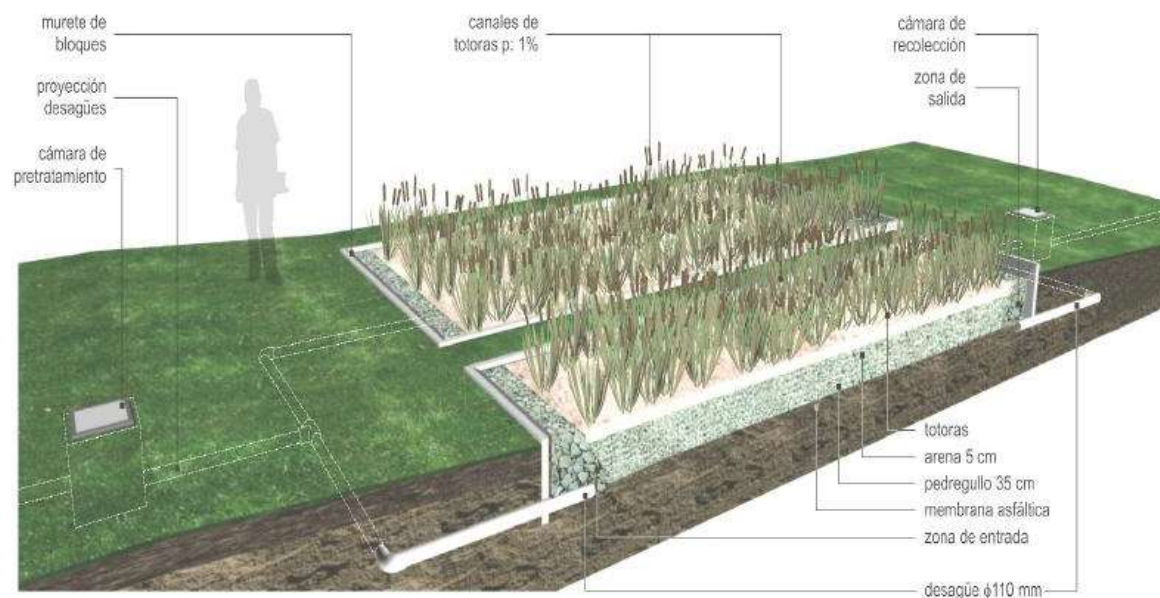
Figura 12. Humedal Artificial. Fuente: www.iagua.es ; 2020.
