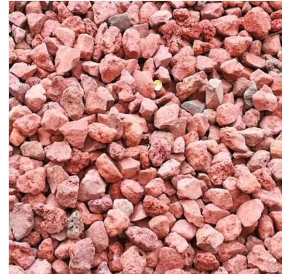
Figura 64. El tezontle es una roca volcánica muy presente en la región central del país, por lo que es ampliamente usada en los jardines. Fuente: www.construrama.com ; 2020.
