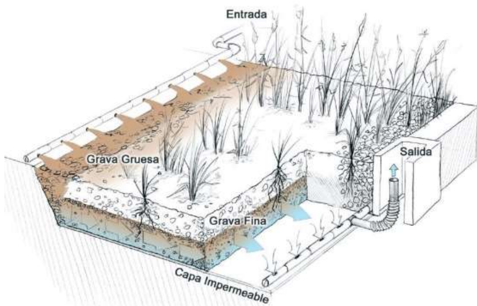
Figura 11. Sistema de depuración natural. Fuente: www.depuranatura.blogspot.com ; 2020.
